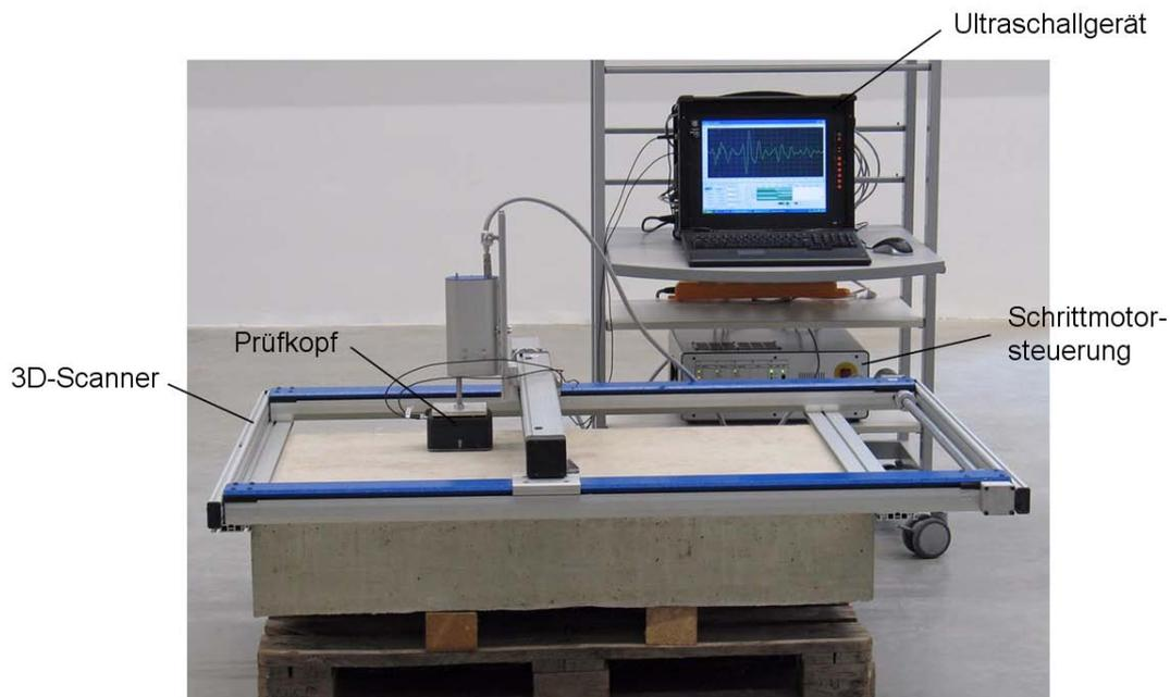
**Bild 3.** Aufbau des automatisierten Abbildungssystems
