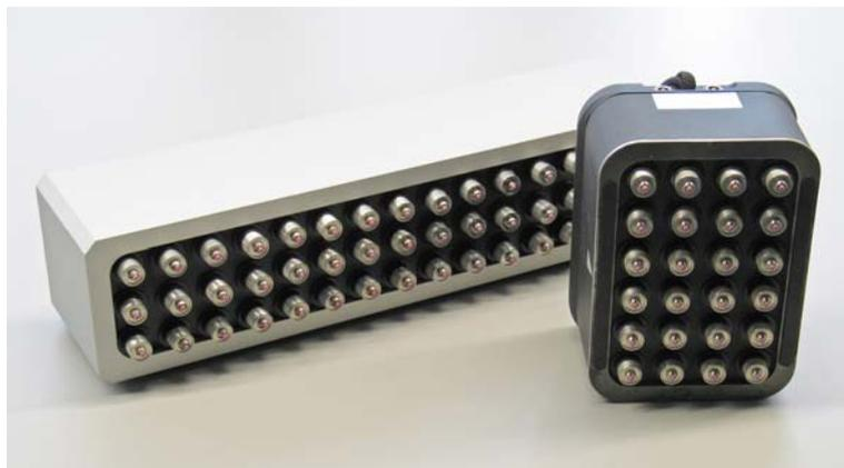
**Bild 5.** Ultraschall-Prüfkopfarray mit 48 Prüfköpfen in 16 Gruppen (links) und einkanaliger Prüfkopf mit je 12 Sende- und Empfangswandlern (rechts)
