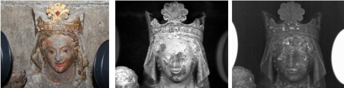
**Abbildung 2:** Kopf der Madonna. Links: Foto. Mitte: Thermogramm während der Blitzlichtanregung (Messbereich: 17,6 bis 42,05°C von schwarz bis weiß mit deutlichem Reflexionsanteil). Rechts: Thermogramm, aufgenommen 3,5 s nach der Anregung (Messbereich: 16,9 bis 20,04°C von schwarz bis weiß). Größe der Thermogramme: 37,5 cm x 28,5 cm.
