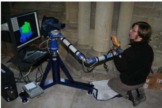
**Abbildung 4:** Lichtschnittsensor mit Gelenkmessarm im Messeinsatz
