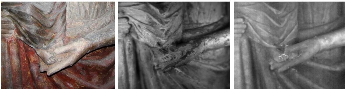
**Abbildung 3:** Hand der Madonna mit Fuß des Kindes. Links: Foto. Mitte: Thermogramm während der Blitzlichtanregung (Messbereich 17,63 bis 36,83°C von schwarz bis weiß). Rechts: Thermogramm, aufgenommen 2,5 s nach der Anregung (Messbereich 16,64 bis 18,73°C von schwarz bis weiß).
